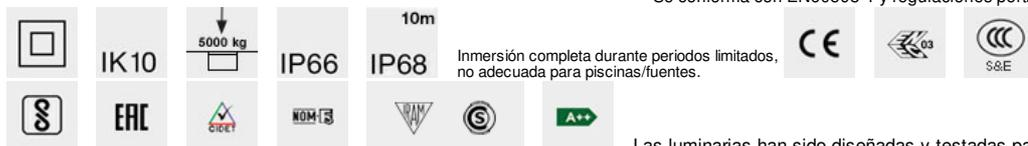
Las luminarias han sido diseñadas y testadas para soportar una carga estática de hasta 50000 N y son ideales para resistir el paso de vehículos con neumáticos. Las luminarias no pueden ser utilizadas en pasajes donde las luminarias se expongan a la tensión horizontal causada por la aceleración, frenado y / o cambios de dirección de los vehículos.
